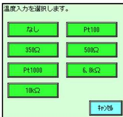
設定値選択画面に戻り、設定値が **なし** に変化します。**設定** キーをタッチし、設定を確定します。設定変更をせず、戻る場合は **キャンセル** キーをタッチし、確認画面で **はい** キーをタッチします。
