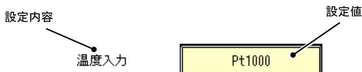
この場合、現在の設定値である **Pt1000** キーをタッチすると、入力種類選択画面に切り換わりますので、選択したい温度入力をタッチします（例として **なし** キーをタッチします）。
