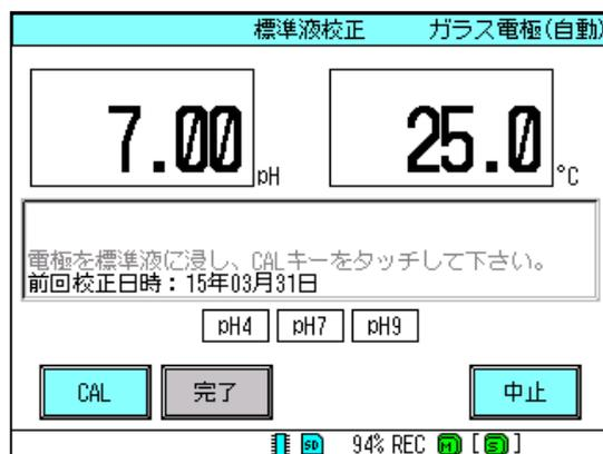
標準液校正の詳細は「10. 標準液校正」を参照してください。
