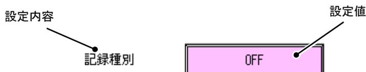
この場合、現在の設定値である **OFF** キー をタッチすると、**瞬時値** ⇒ **平均** ⇒ **最大値/最小値** ⇒ **OFF** ... と変化します。設定したい内容を、キーをタッチして表示させてください。表示させた後、**設定** キーをタッチし、設定を確定します。設定変更をせず、戻る場合は **キャンセル** キーをタッチし、確認画面で **はい** キーをタッチします。
